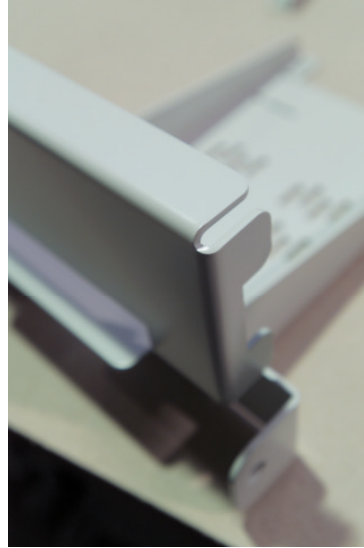
Auch hochgenaue Kantungen erledigt der Roboter pausenlos und überaus zuverlässig.
