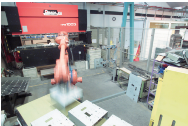
Größere Stückzahlen sowie schwere und ausladende Teile manipuliert seit zwei Jahren der Roboter.
